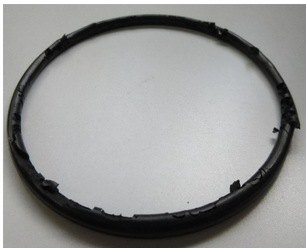
図5 劣化したOリング
