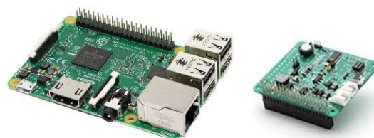
図 4. Raspberry Pi3(左)及び slee-Pi2(右)外観
