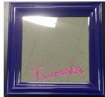
図1 銀鏡反応で作製した鏡。
